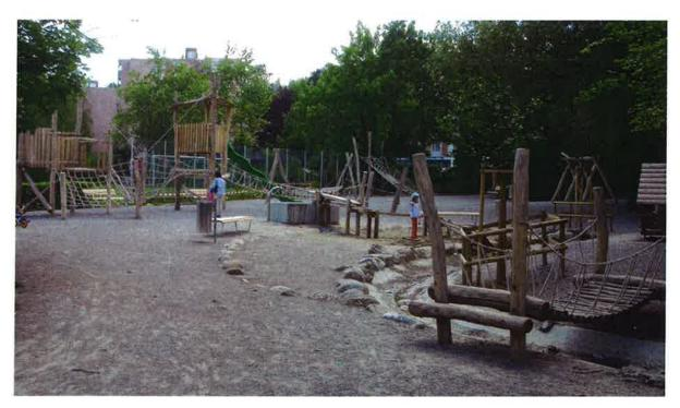
Auf dem Spielplatz im GZ Loogarten in Altstetten wurden rohe, geschälte und unbehandelten Robinienstämme verwendet. Um die Lebensdauer zu erhöhen. wurden die tragenden Stämme nicht direkt in Beton versetzt. Alleinstehende Standofosten wurden direkt in einem Fundamentrohr eingesandet. Das Wasser kann durch den Sand schnell abfliessen und das Holz hat Platz zum arbeiten.
