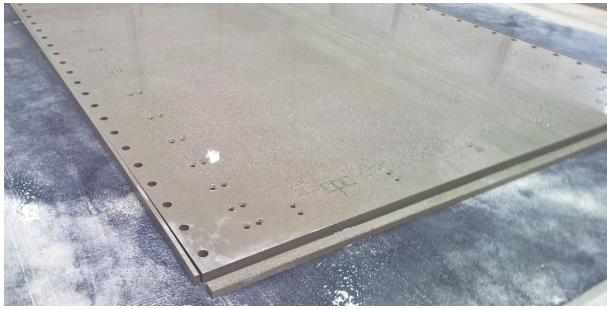
Bild 9 Fertig bearbeitete Brückenplatte im CNC-Zentrum (Silidur AG) Bridge deck completed in the CNC-machining centre (Silidur AG)
