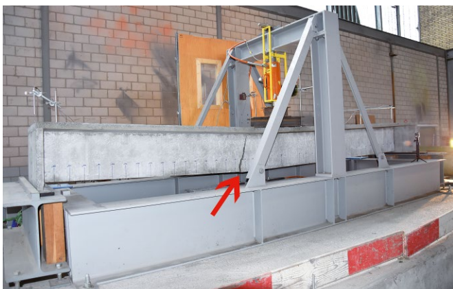
Bild 7 Vier-Punkt-Biegeversuch mit Riss zum Bruchzeitpunkt (ZHAW) Four-point bending test with crack at point of failure (ZHAW)
