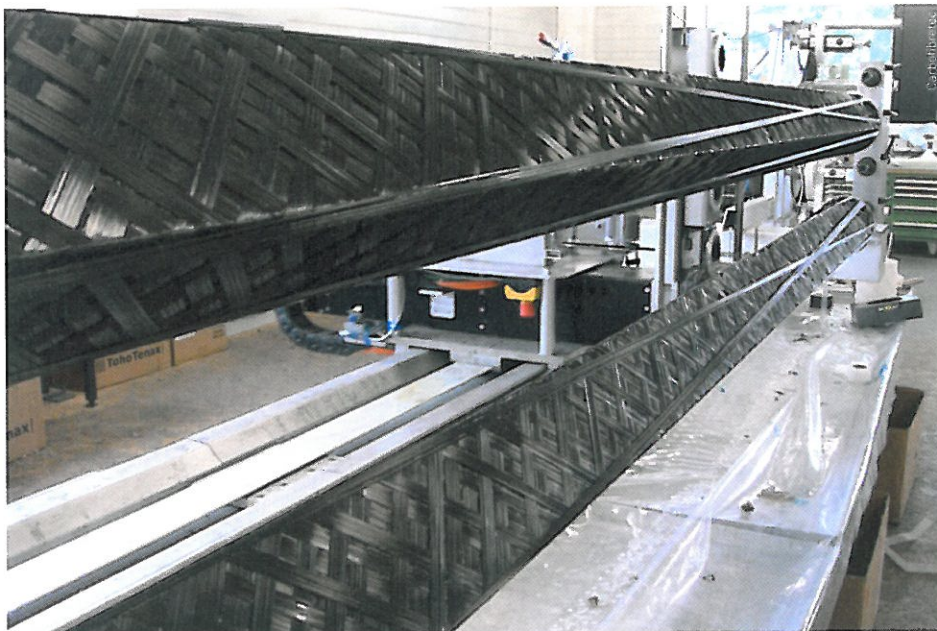
Die CFK-Träger werden im Wickelverfahren produziert.
