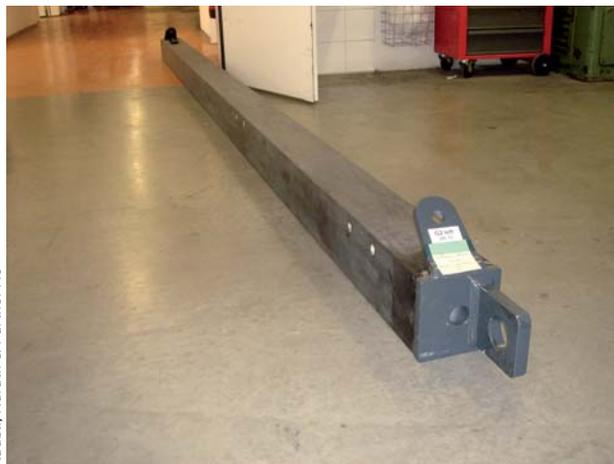
Abb. 7: Fachwerkstab mit Endknoten in Stahl und innerer Vorspannung
