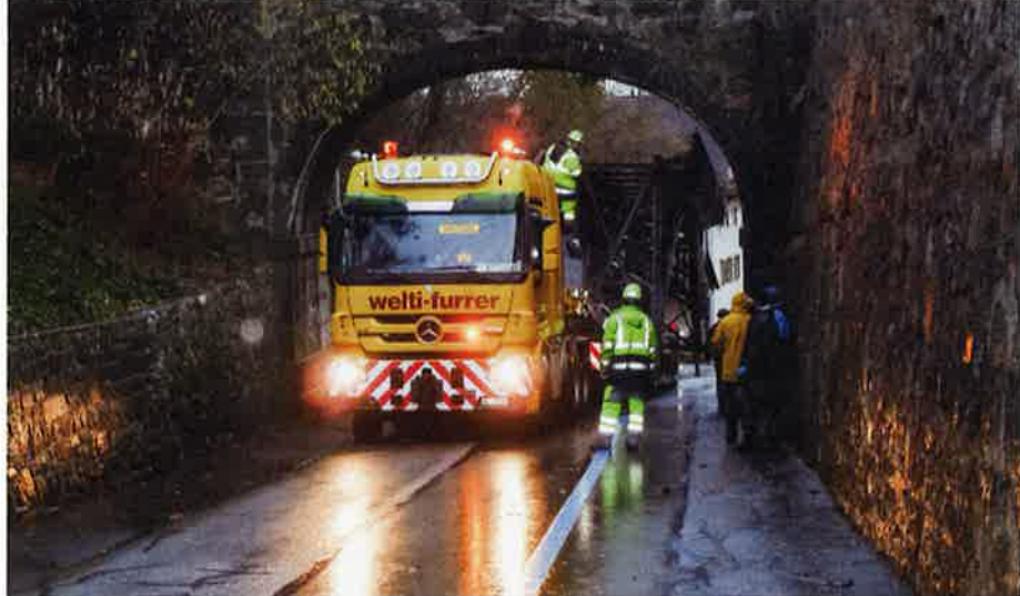
Bereits nach wenigen Metern Fahrt hatte der Tieflader mit seiner schweren Last im Gepäck die erste kritische Durchfahrt zu bewältigen. Eine Millimeter-Angelegenheit, die zuvor genau überprüft wurde.
